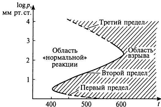
Рис. 2.2. Взрывные пределы стехиометрической смеси \text{H}_2 + \text{O}_2 в сферическом сосуде (диаметром 7,4 см), покрытом \text{KCl} [43]
